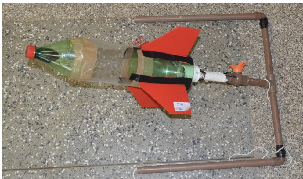
Figura 1. Foguete artesanal e base de lançamento, construídos com garrafa pet.
