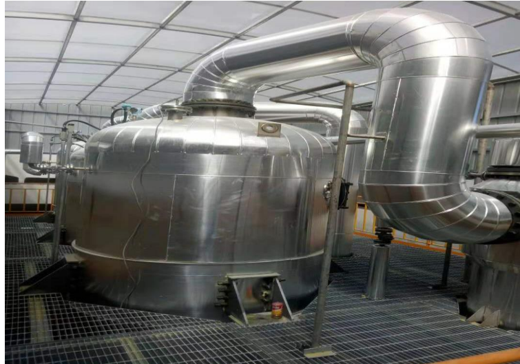
Figura 3. Curva de Gomos em uma refinaria de Óleo Vegetal.
