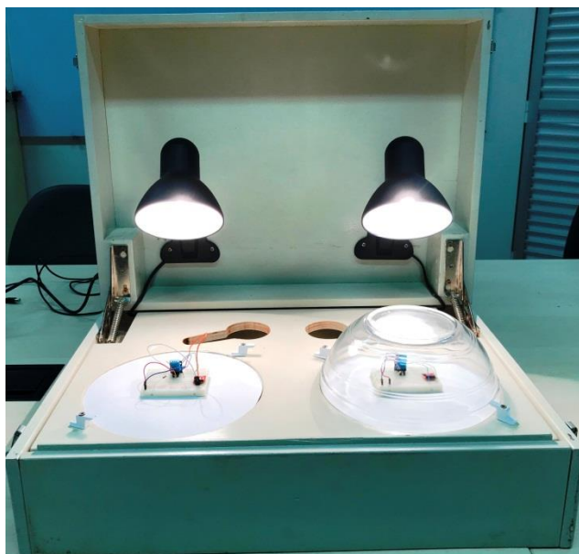
Figura 9. Fotografia do experimento realizado, no ambiente da esquerda o sensor fica livre, enquanto no da direita o sensor fica dentro do ambiente delimitado pela cúpula de vidro, a qual simula a atmosfera do Planeta Terra.
