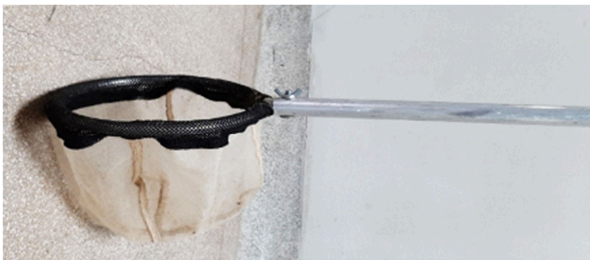
Figura 4. Rapiché, equipamento destinado à amostragem de macroinvertebrados bentônicos utilizado na APA Lago do Amapá, Rio Branco, Acre.
