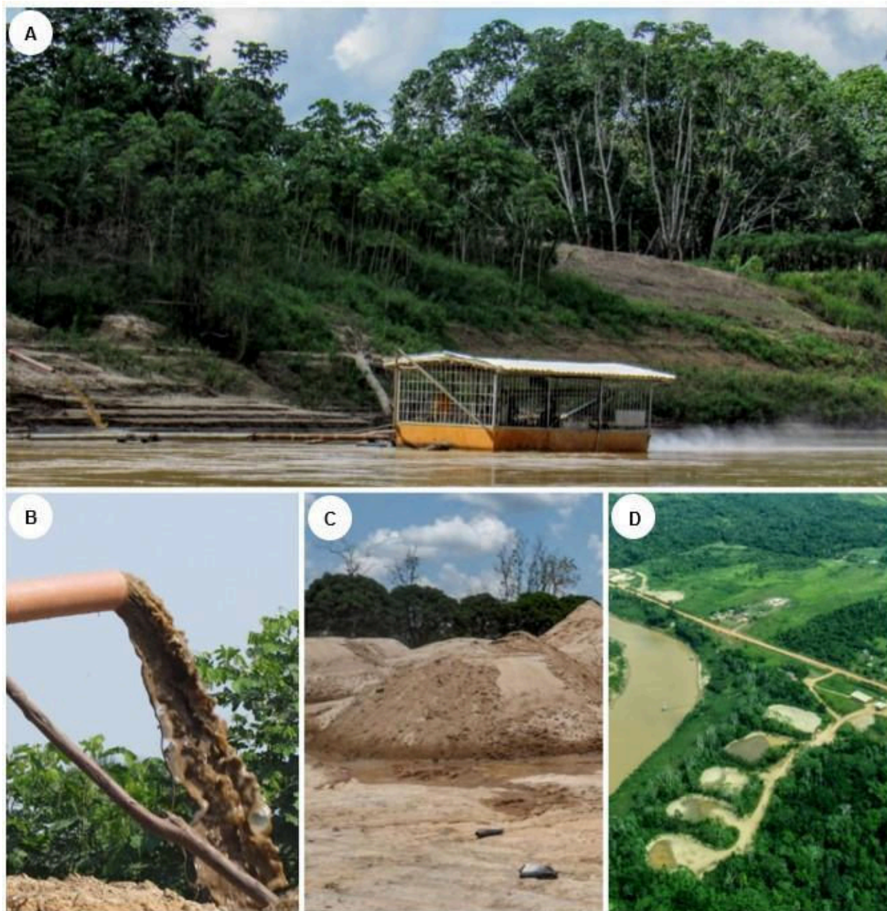
Figura 8. Mineração de areia na APA Lago do Amapá, Rio Branco, Acre. A. Draga em pleno funcionamento no rio Acre, B. Água e areia succionadas do rio pela draga, sendo depositadas na cancha, C. Areia na cancha preparada para o transporte, D. Vista aérea das canchas de areia em uma empresa localizada no ramal Riozinho.
