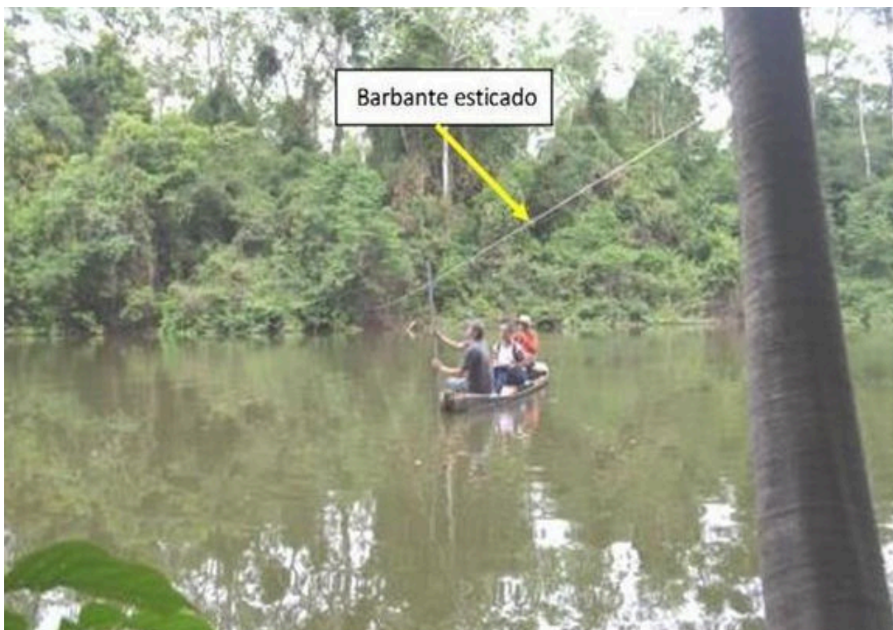
Figura 4. Metodologia do barbante utilizada para as medidas de largura e profundidade do lago Amapá, Área de Proteção Ambiental Lago do Amapá, Rio Branco, Acre. Foto: Adriano Bortoloni - outubro/2015.
