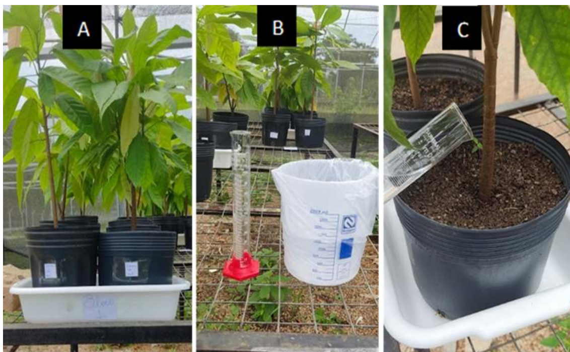
Figura 2. Cacau em bandejas para contaminação do solo (A); Preparo da solução de cádmio (B); Contaminação do solo (C).
