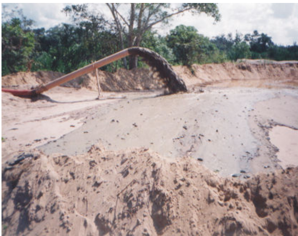
Figura 4. Mistura de água, areia, silte e argila, denominado de polpa. Fonte: Accorsi (2001).
