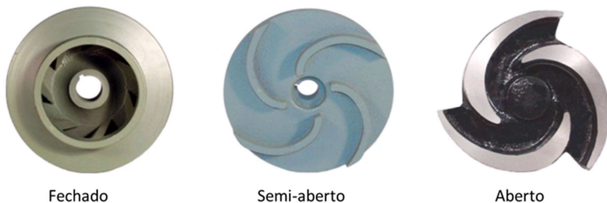
Figura 1. Classificação de rotores de bombas centrífugas Fonte: (BRASIL, 2010).
