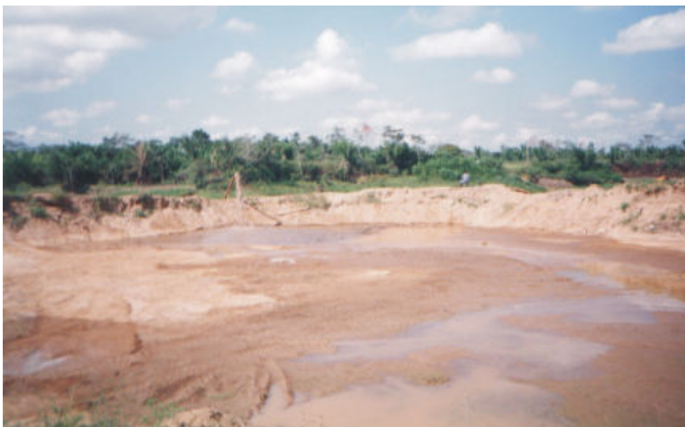
Figura 5. Pátio de estocagem ou “poço de decantação” recebendo o material extraído do fundo do rio.
