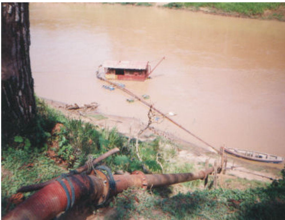
Figura 3. Motor de sucção, instalado em balsa, extraindo material do fundo rio. Fonte: Accorsi (2001).
