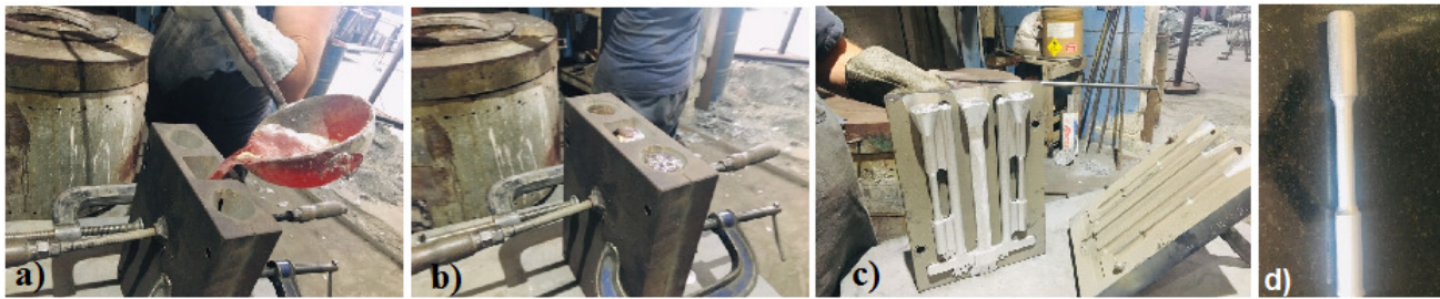
Figura 16. Vazamento dos CDP's. a) Transporte manual com concha. b) Molde fechado aguardando o resfriamento do material. c) Molde aberto com os CPD's. d) CPD sem canais e massalotes.
