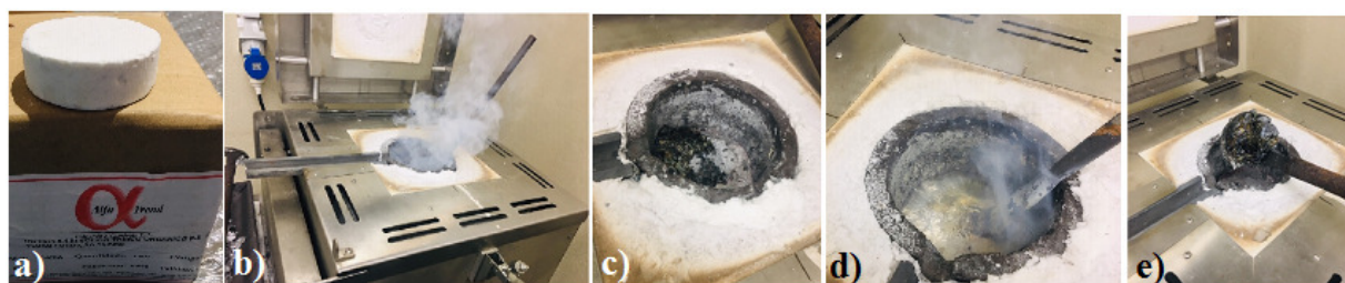
Figura 13. Tratamento do material com pastilha. (a) Pastilha de Hexafluoreto de alumínio. (b) Mergulhada com um sino no banho. (c) Agitação do banho. (d) Remoção das escórias.
