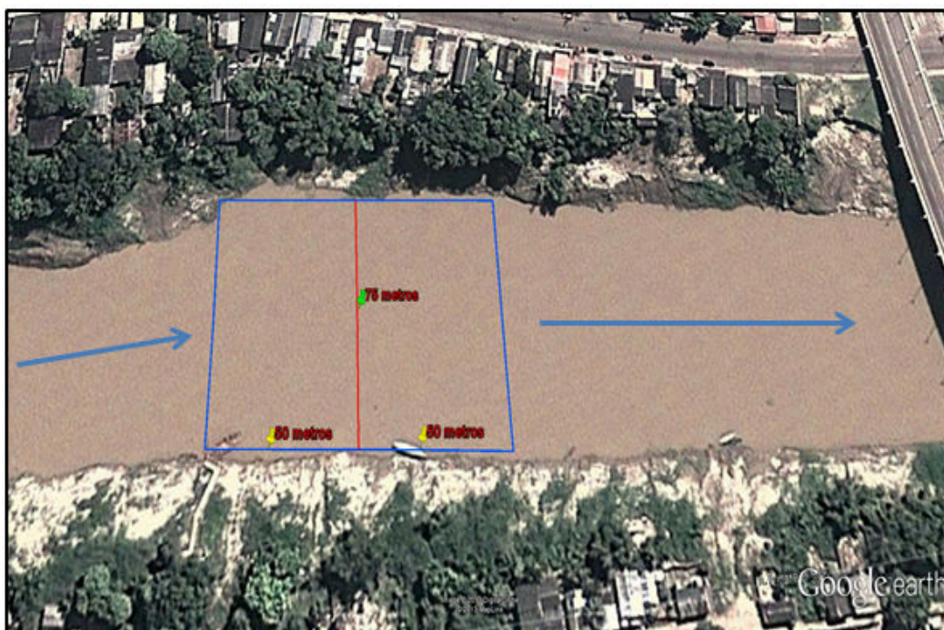
Figura 5. Seção longitudinal do rio Acre para o cálculo do volume de material assoreado no leito do rio.
