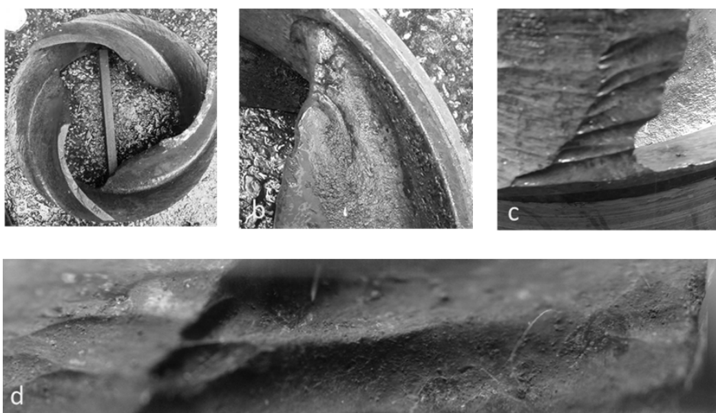
Figura 12. Desgaste por abrasão de sedimentos em um rotor aberto de bomba centrífuga (FLYGT): a) Vista frontal da parte posterior do rotor; b) Zona de cisalhamento da pá; c) Desgaste da zona de saída; d) Sulcos de erosão na extremidade de saída do rotor.
