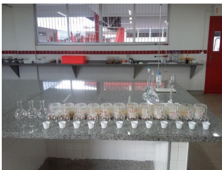
Figura 1. Amostras de solos incubadas em recipientes plásticos de 500 cm 3 abertas para troca de ar e retirada do NaOH para posterior titulação.
