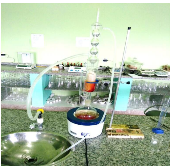
Figura 2. Extração do óleo essencial em extrator soxhlet liofilização. Colorado do Oeste, RO, 2017.
