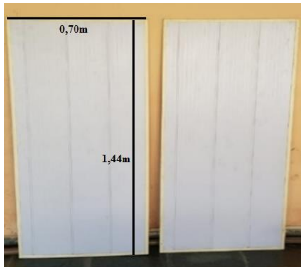
Figura 1. Placas de forro PVC.
