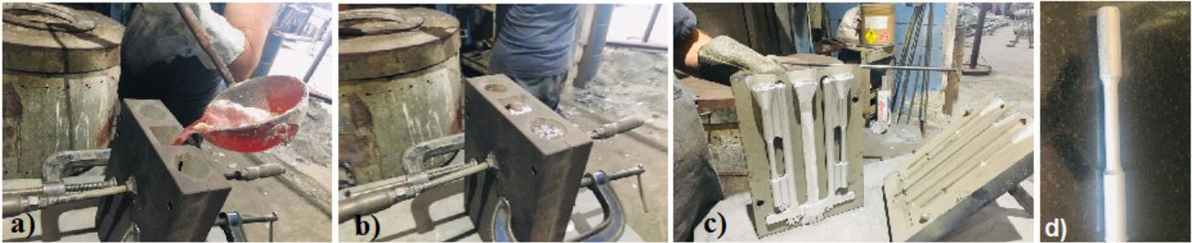
Figura 16. Vazamento dos CDP's. a) Transporte manual com concha. b) Molde fechado aguardando o resfriamento do material. c) Molde aberto com os CPD's. d) CPD sem canais e massalotes.
