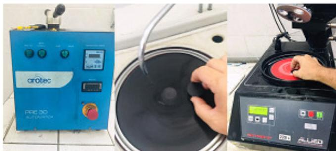
**Figura 15.** Embutimento, lixamento e polimento.
