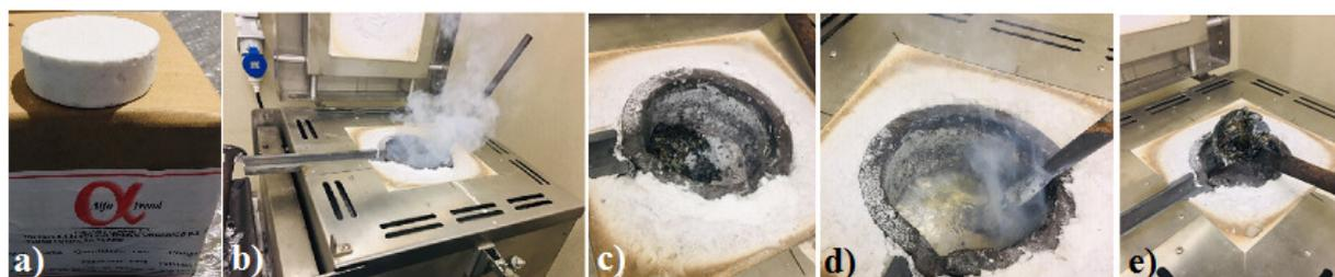
**Figura 13.** Tratamento do material com pastilha. (a) Pastilha de Hexacloroetano. (b) Mergulhada com um sino no banho. (c) Agitação do banho. (d) Remoção das escórias.
