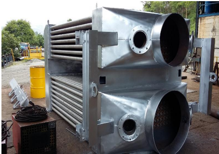
Figura 5. Trocador de calor para indústria de Bioenergia.
